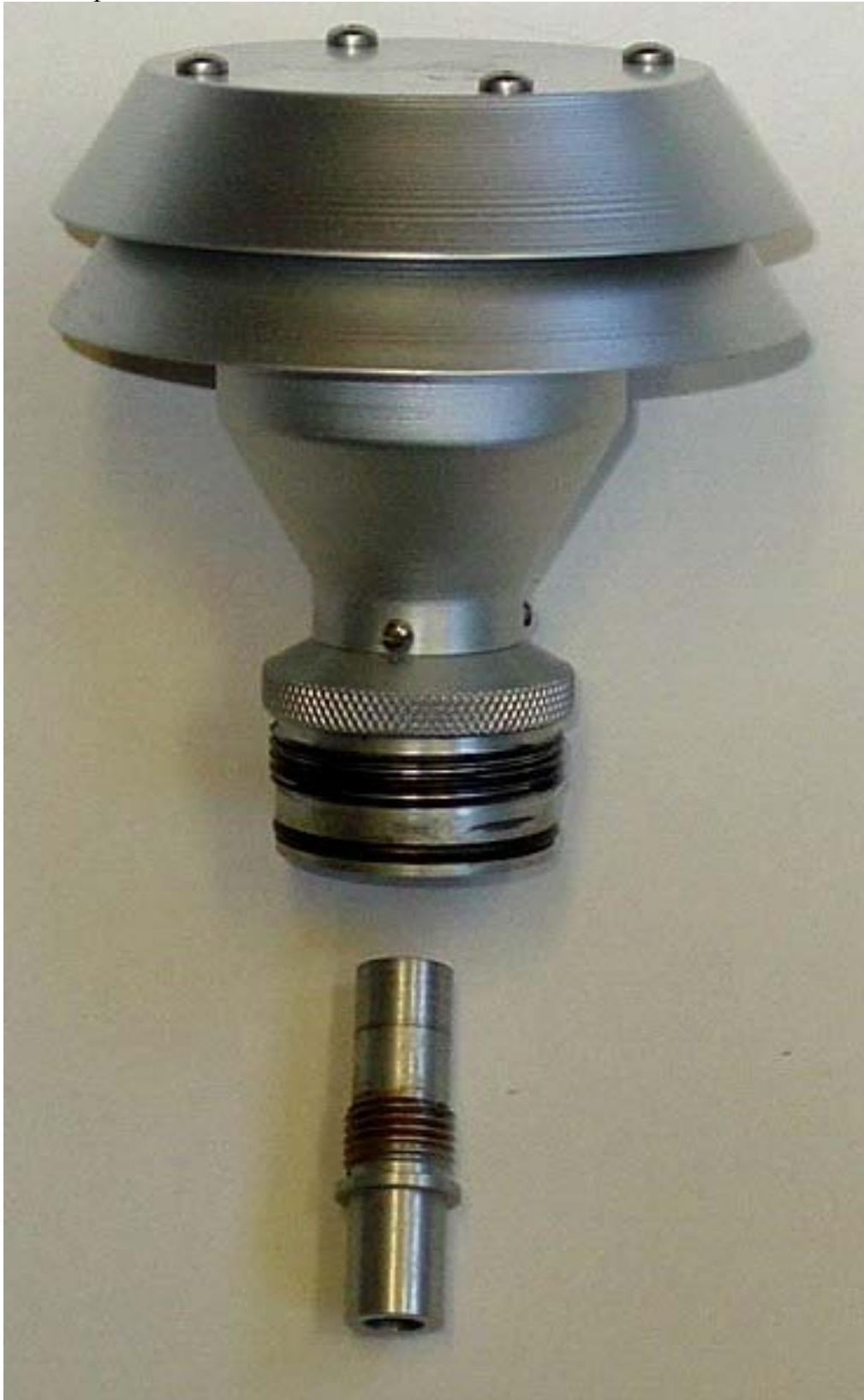
Figura 11: Foto del Desensamble del Chorro para su Limpieza o Cambio de Tamaño
